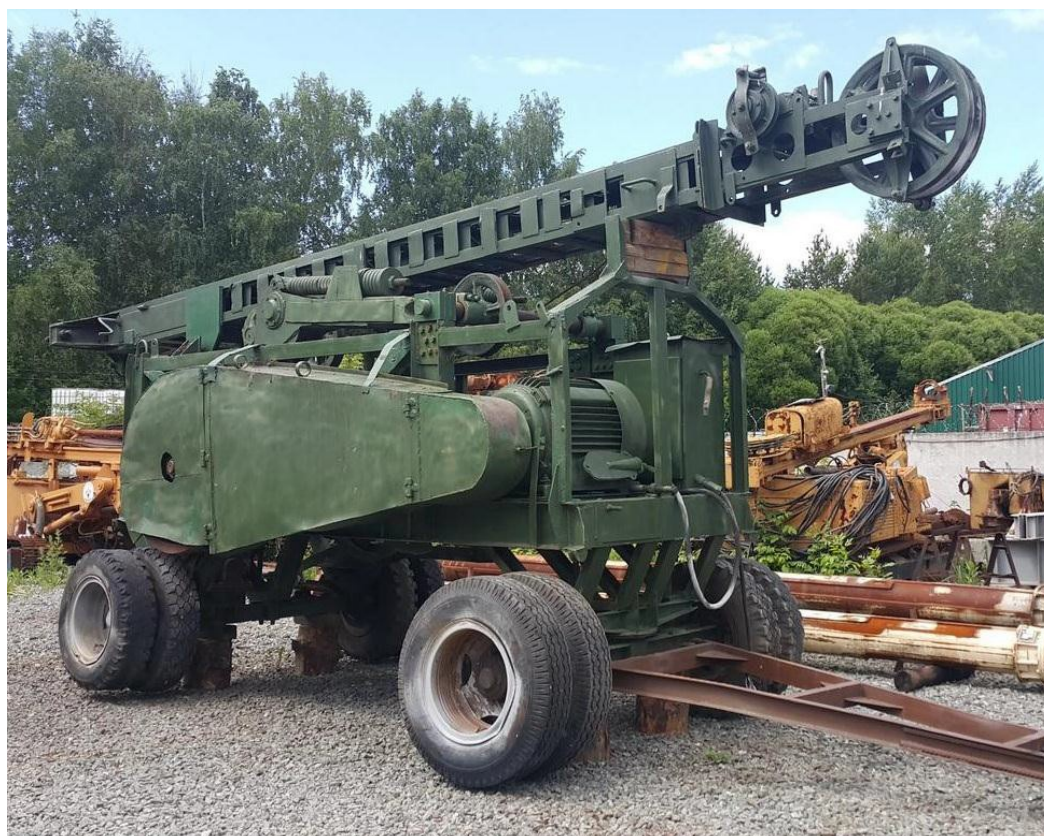
Сурет 4.6 - УКС-22 М бұрғылау қондырғысы
